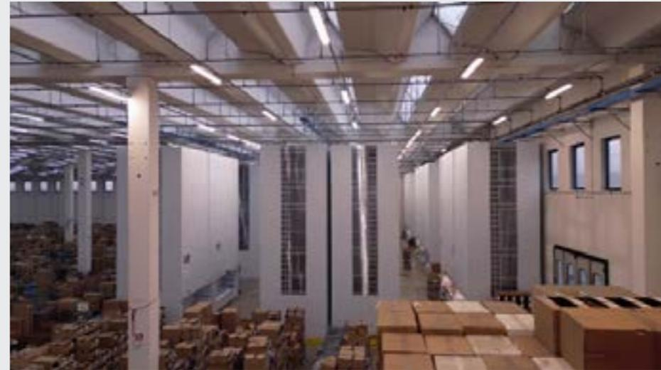
L'installazione di tale tecnologia permette l'**ottimizzazione degli spazi** dei magazzini ed il miglioramento e l'ottimizzazione delle fasi di picking da parte degli operatori. Gli operatori dedicati al funzionamento dei modula variano in base al periodo. In media, il funzionamento di tale tecnologia necessita il coinvolgimento di 10 operatori totali.
